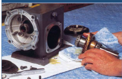
Odtłuszczenie części metalowych
